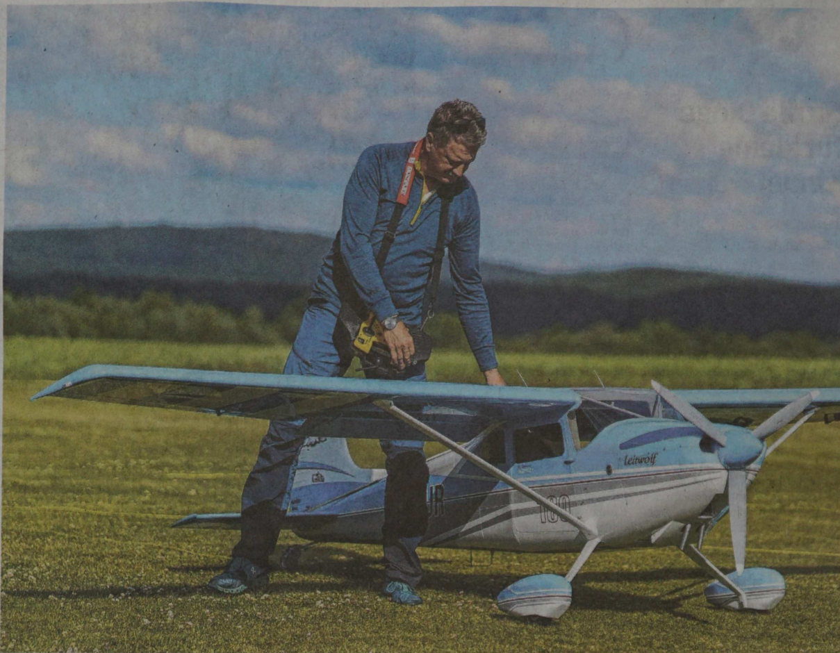
Die Cessna 180 wird von zwei Teams eingesetzt, hat vier Meter Spannweite und einen Vier-Zylinder- sowie 200-Kubikzentimeter-Boxermotor unter der Haube. Besitzer Ulf Reichmann ist seit 1995 an allen F-Schlepp-Wettbewerben in Brettheim dabei. Foto: privat
